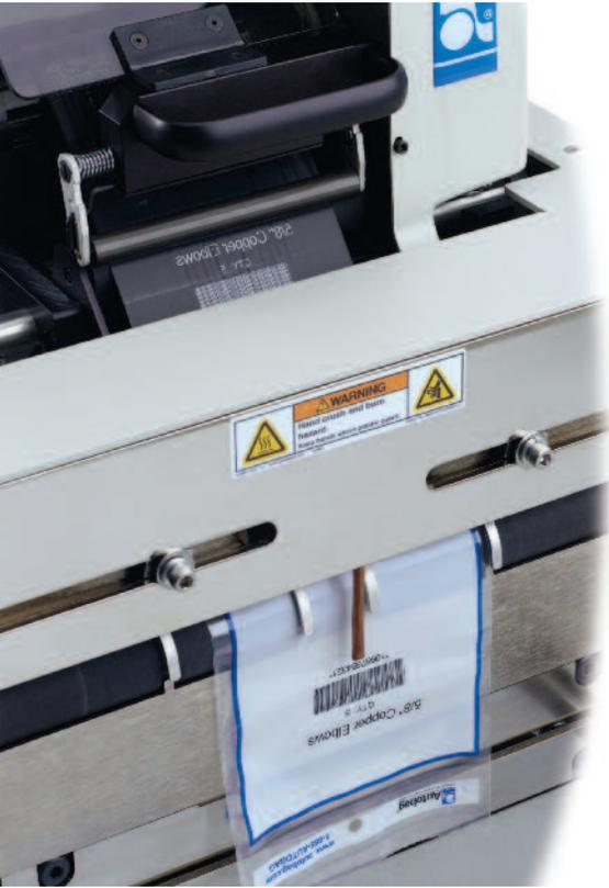
La máquina Autobag AB 180 OneStep está especialmente diseñada para proporcionar soluciones flexibles en ambientes de embalaje dinámicos, como la gestión de pedidos por correo, trabajos de producción cortos y operaciones de montaje a pedido. Al ubicar la impresora PI 412c directamente sobre la siguiente bolsa a ser cargada, la máquina AB 180 OneStep imprime e indexa en un solo paso, eliminando prácticamente el desperdicio de bolsas y la espera en fila del producto.
